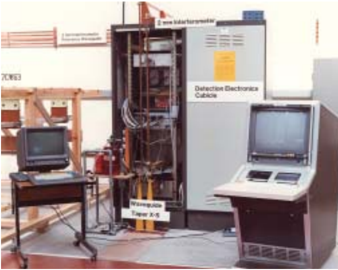
Rijnhuizen bouwde meetapparatuur voor JET, waaronder deze 2 mm-interferometer.
