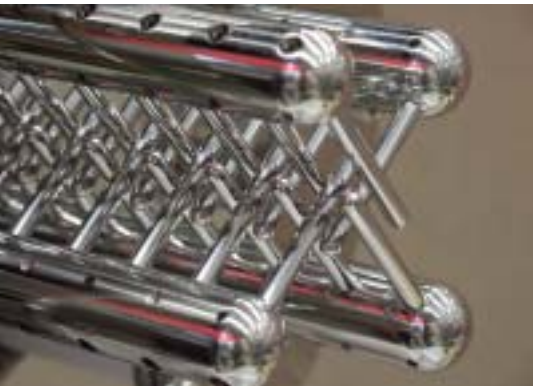
Apparatuur voor het afremmen van neutrale moleculen
