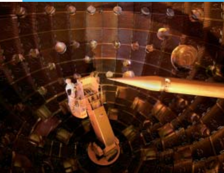
192 laserstralen komen samen in het middelpunt van deze target chamber van de National Ignition Facility (Californië).
