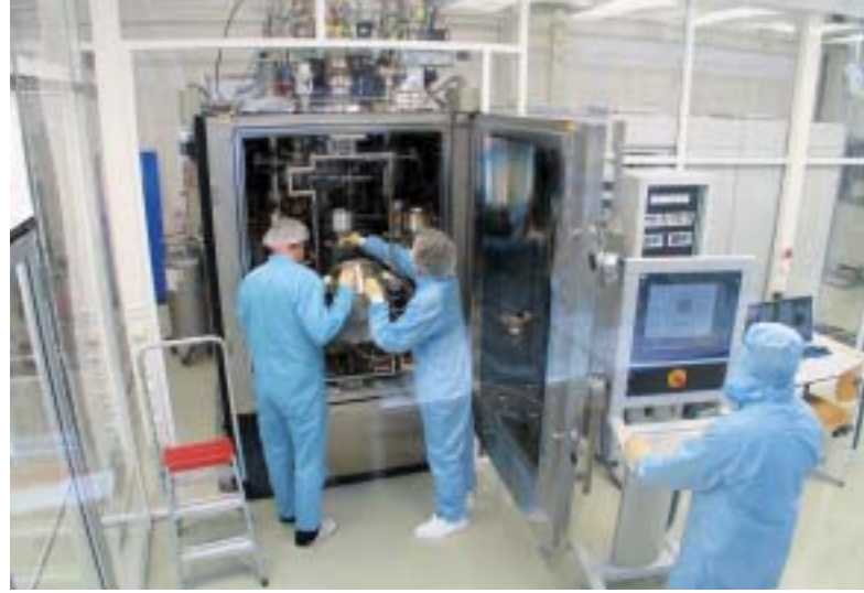
Meerlaags-depositiemachine ADC: hierin worden de spiegels laag voor laag opgedampt, elke laag slechts enkele atomen dik.
