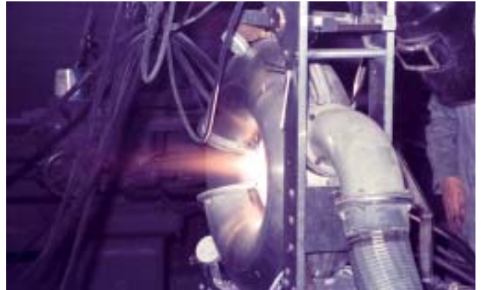
Schroefpinch SP IV wordt gelast
